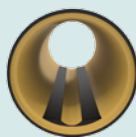
Alle Systeme können auch mit Trockenwetterrinne ausgeführt werden.
